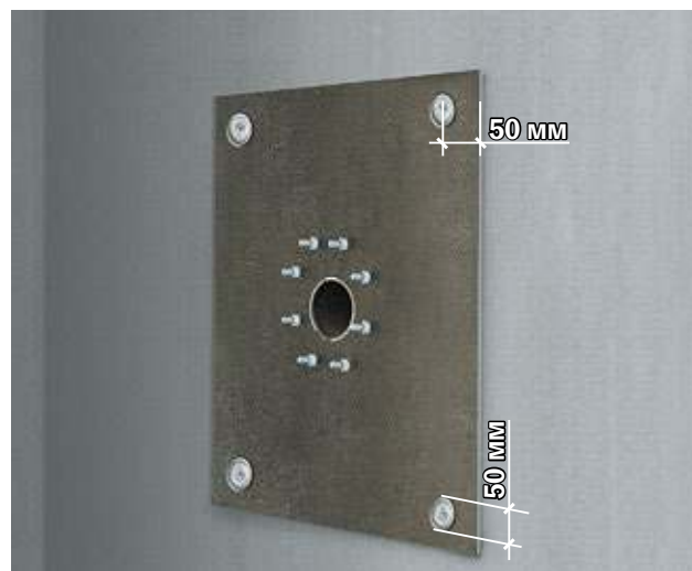
Рисунок 5.3. – Механическая фиксация слоя усиления в месте перехода с вертикальной на горизонтальную поверхность и трубной проходки
