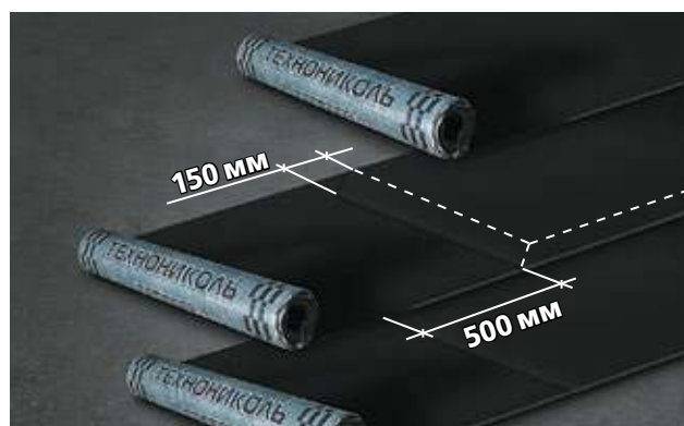
Рисунок 4.6. – Разбежка торцевых швов смежных рулонов
